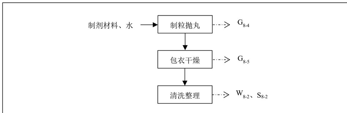
3.3.2.9-3 制剂实验流程及产污环节图
