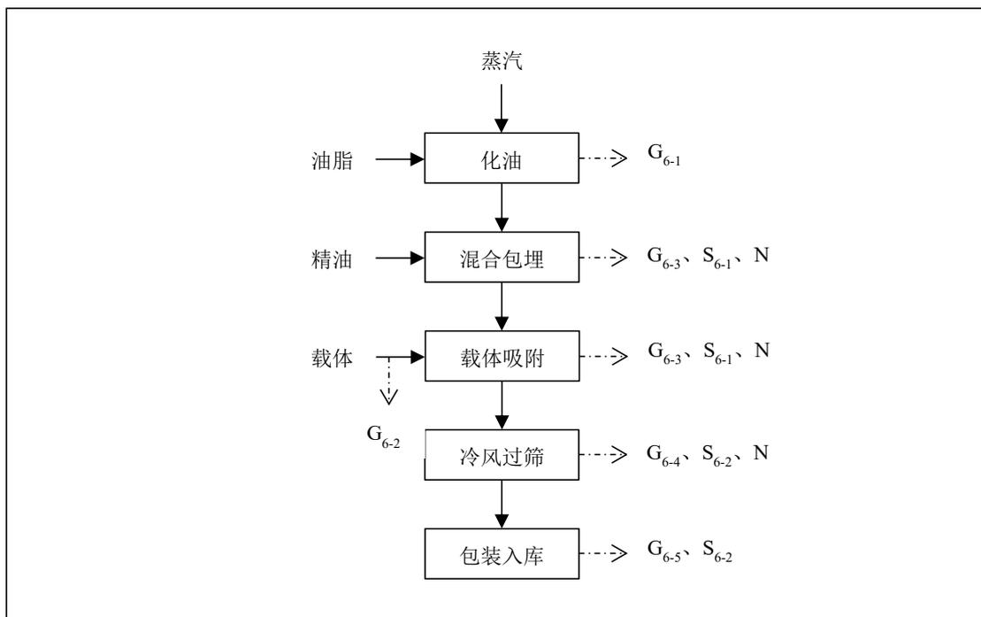
图 3.3.2.7-1 化油附载工艺流程及产污节点图
