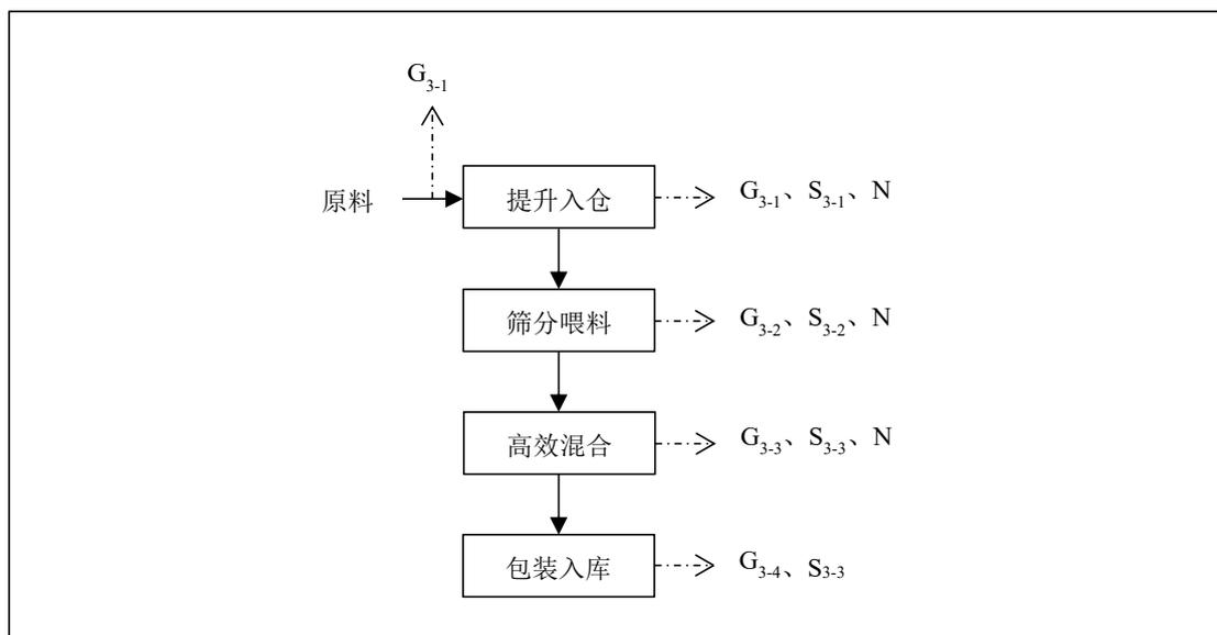
图 3.3.2.4-1 高效混合工艺流程及产污节点图
