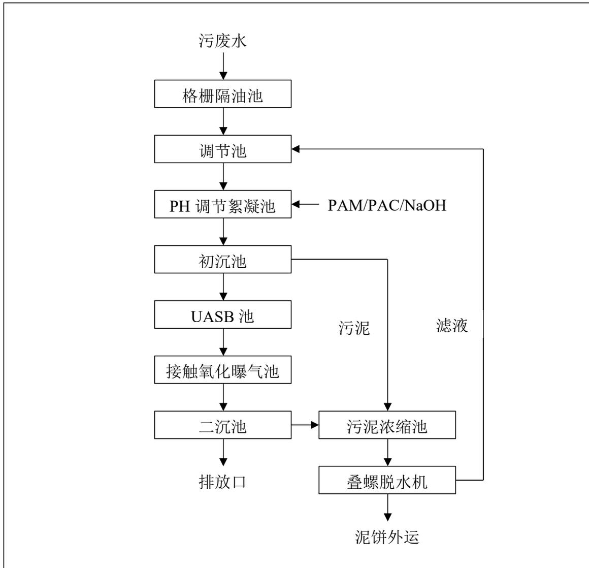
图 6.2.2-1 污水处理工艺流程图
