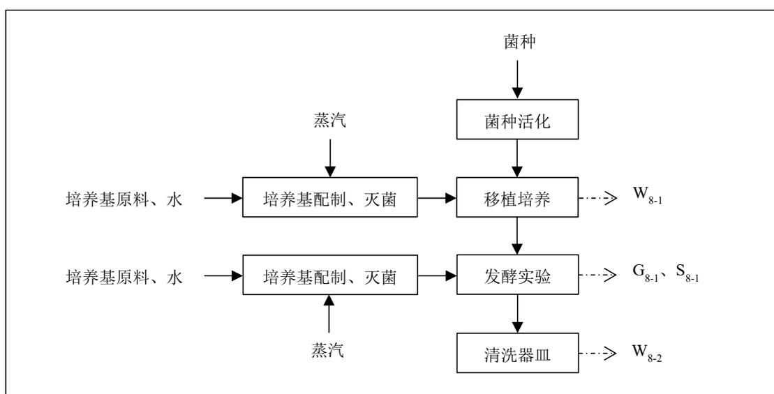
3.3.2.9-1 微生物发酵实验流程及产污环节图
