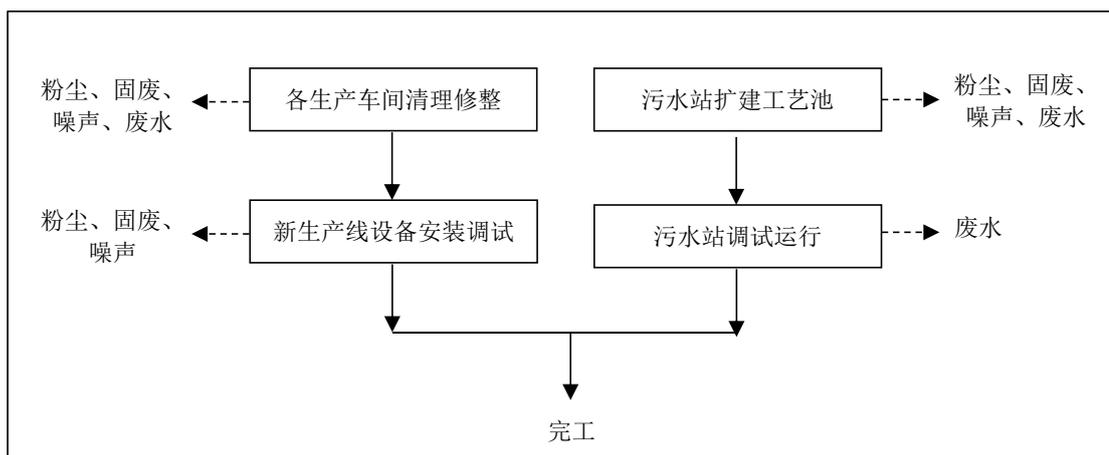
图 3.3.1-1 施工期工艺流程及产污环节图
