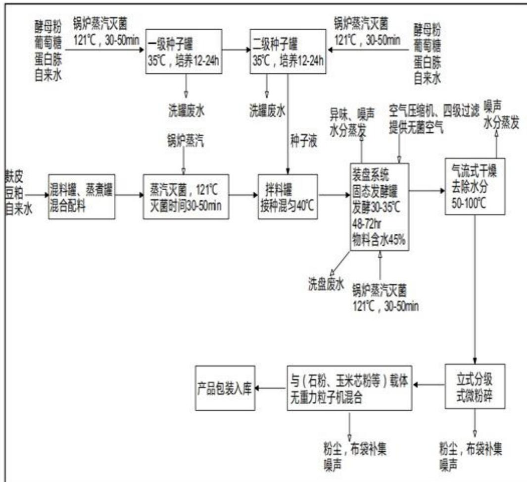
图 3.1.2.4-2 倍健素生产工艺流程及产污节点图
