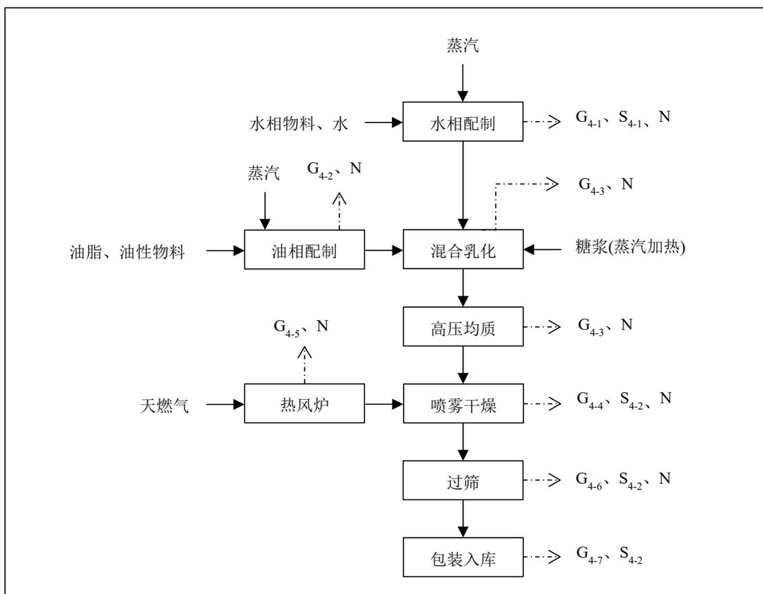
图 3.3.2.5-1 喷雾干燥工艺流程及产污节点图
