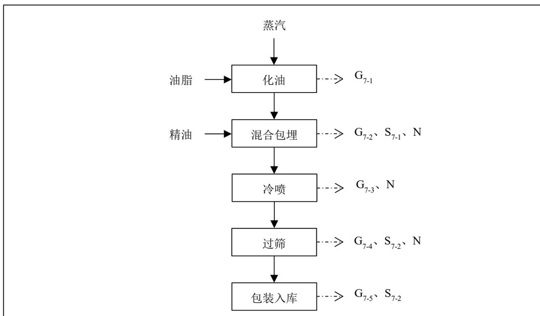
图 3.3.2.8-1 化油冷喷工艺流程及产污节点图
