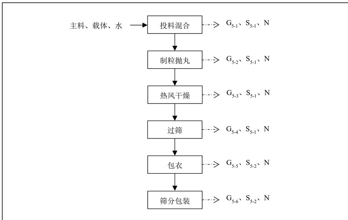
图 3.3.2.6-1 制料包被工艺流程及产污节点图
