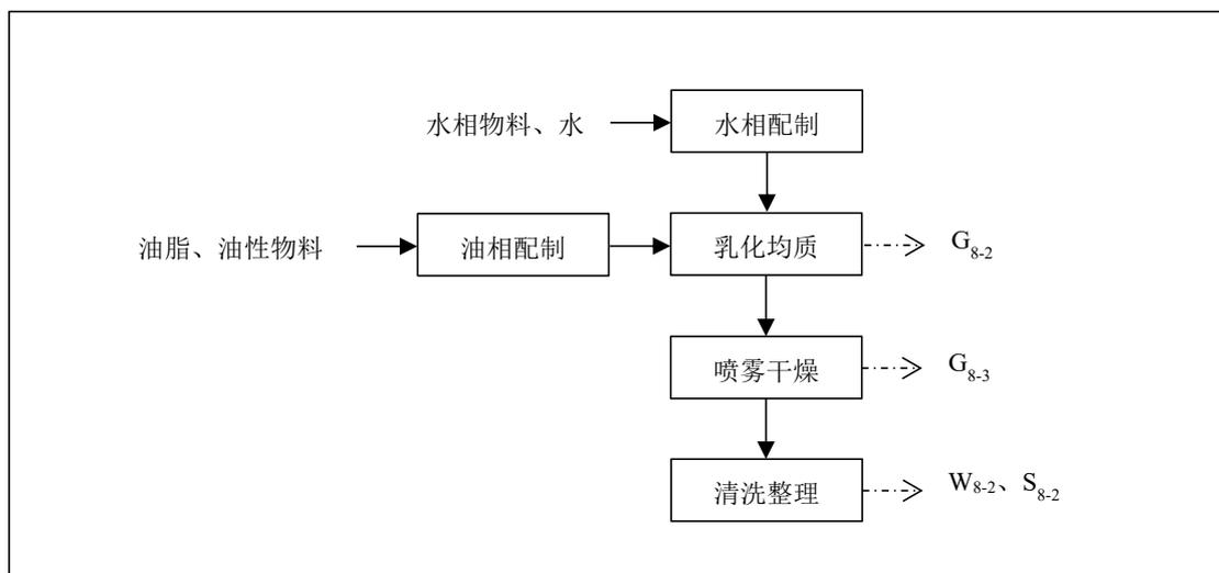
3.3.2.9-2 乳化微胶囊实验流程及产污环节图
