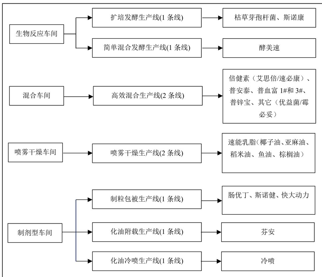
图 3.2.2.1-1 项目车间——生产线——产品设计图
